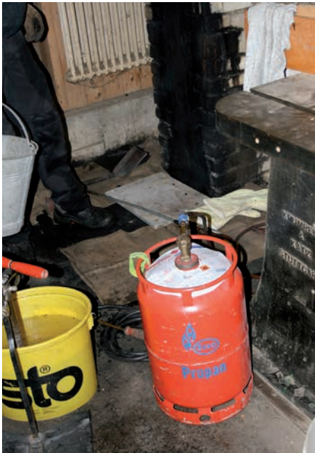
Eimerspritze zum Löschen oder Kühlen und Propangas zum Ausbrennen.
