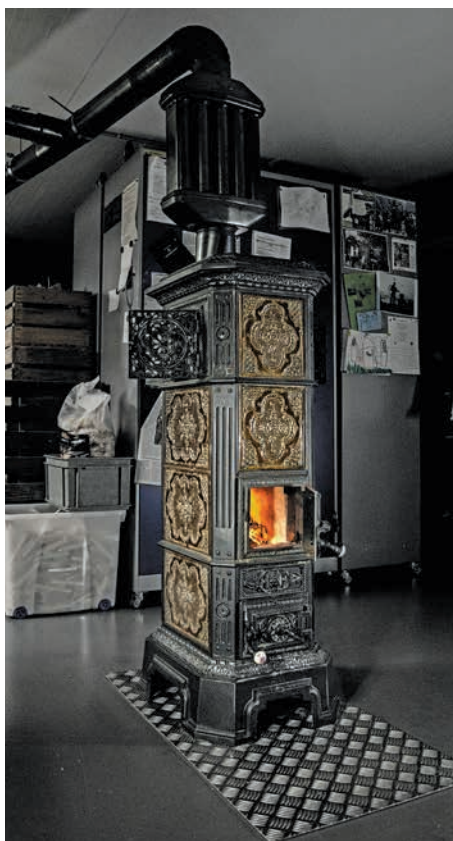
Durch Kurt Fischer komplett restaurierter Kacheltragofen in der Kaminfegerwerkstatt.
