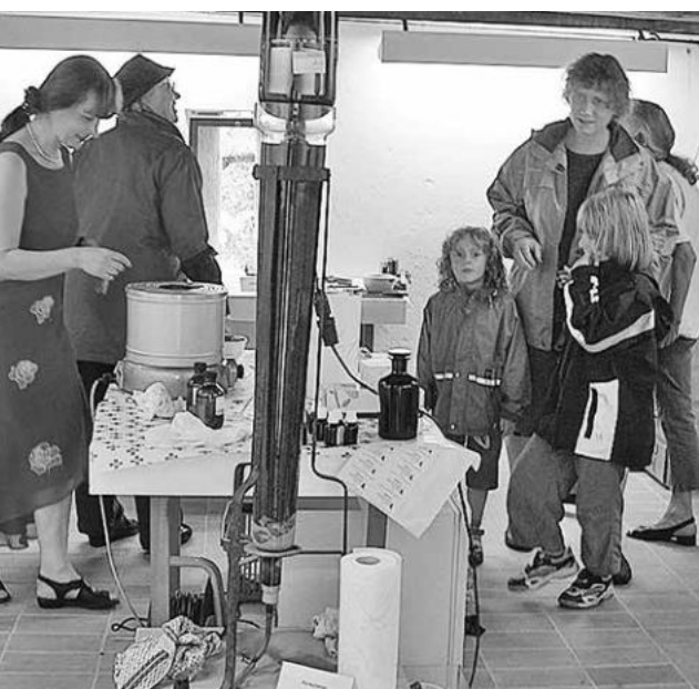
Ausstellung im Heimatmuseum Schinznach-Dorf. Im Vordergrund der Perkolator, in dem Baldriantinktur hergestellt wird.
