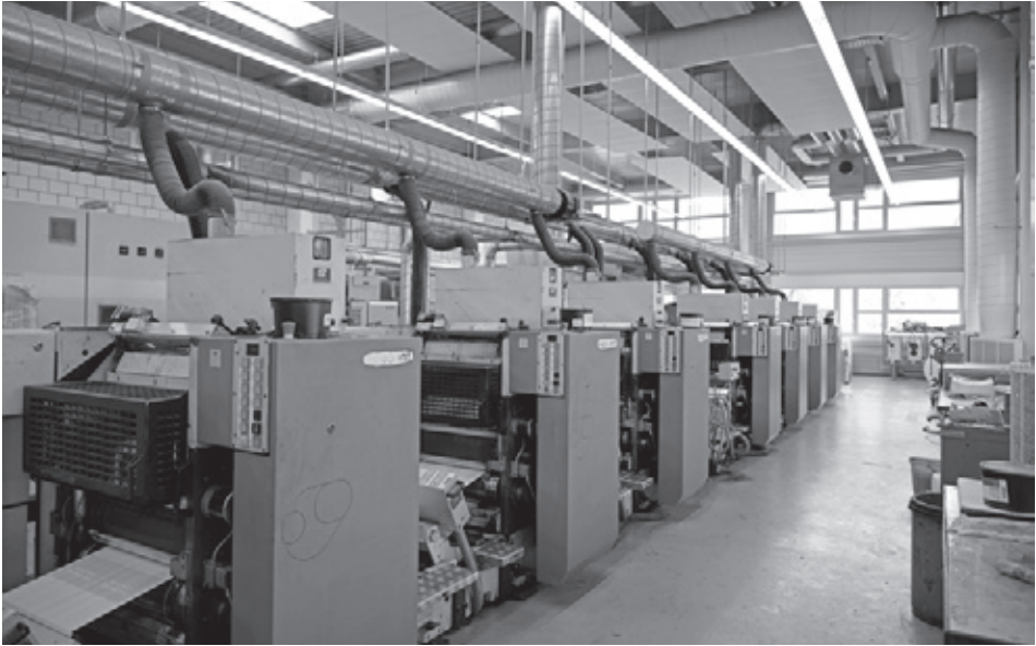
Achtfarben-Endlos-Offsetdruckmaschine Goebel Ecoprint.
