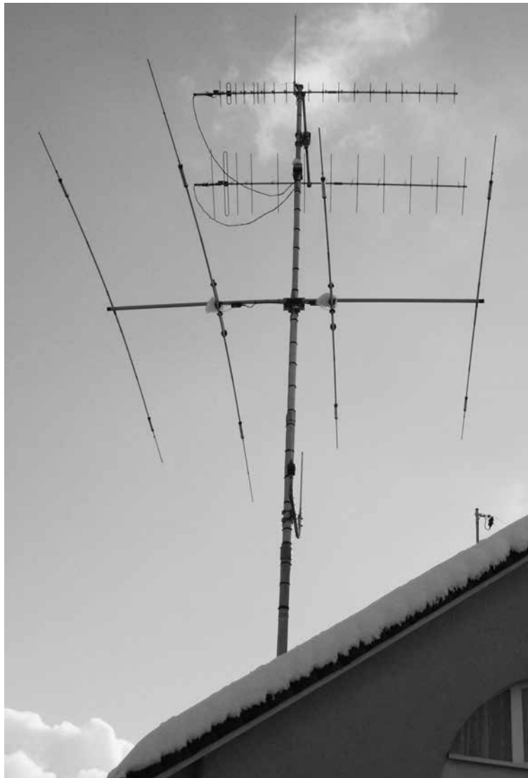
Typische, drehbare Amateurfunkantenne: Kurzwellenyagi-antenne mit darüber liegenden Kreuzyagis für den Satellitenfunk. Drehbar in Azimut und Elevation
